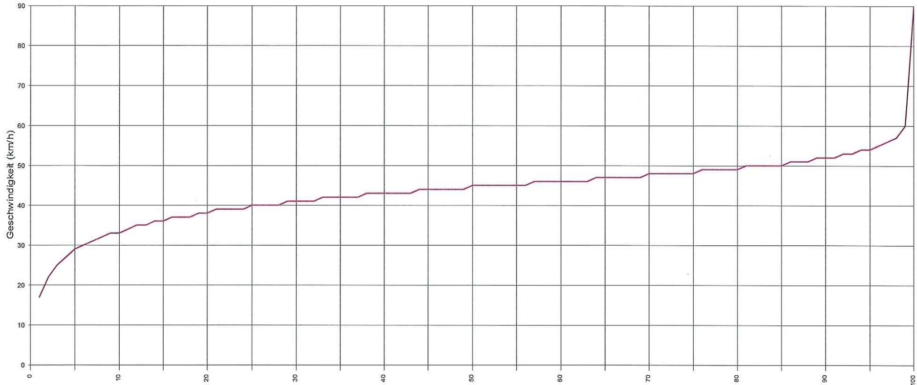
Statistik Vx (%) Hinweis: x % der Fahrzeuge, fahren langsamer oder maximal y km/h
